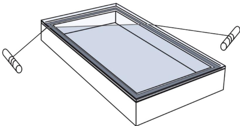
Am effektivsten lassen sich miteinander verbundene Flächen durch das Aufschneiden des Klebebandes wieder trennen. Dazu empfehlen wir zum Beispiel Klavierdraht oder eine scharfe Klinge. Mit diesen Werkzeugen schneiden Sie vorsichtig durch das Klebeband.
