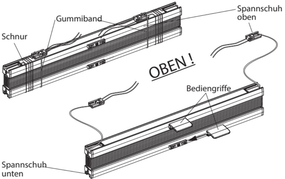
5. Die unteren Spannschuhe aus der Schiene nehmen
