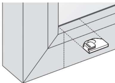
2. Verdrehsicherung unten in den Befestigungshalter - Flach einsetzen.
