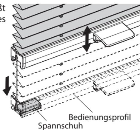
Nach der Funktionskontrolle können die überstehenden Schnüre abgeschnitten werden.
