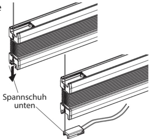
6. Die oberen und danach die unteren Spannschuhe auf die montierten Halteplättchen schieben, bis sie einrasten.
